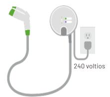
requiere para una secadora de ropa o un rango eléctrico. El Nivel 2 se encuentra en muchos lugares públicos y en el lugar de trabajo, pero ambién en muchos hogares. Se utiliza un conector estándar que se puede conectar a cualquier vehículo eléctrico, ya sea directamente o mediante un adaptador.
